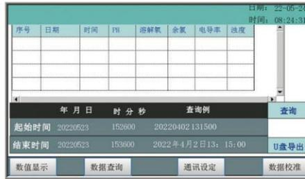
4. 系统设定:此画面可设定各个参数的查询显示没有的参数可关闭不显示，设备地址头485通讯的从机地址位，本设备可进行485通讯数据，可设定 485通讯的从机地址。通讯协议为: 9600, N, 8, 1.
