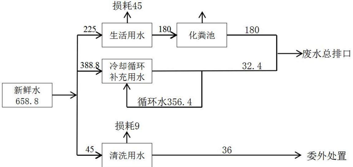
图 2-1 项目用水平衡图 (t/d)
