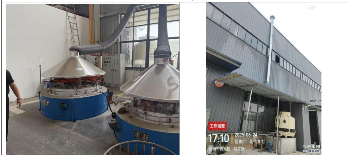
废气处理装置（氮化炉自带的尾气燃烧装置）和排放口（DA006）
